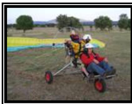
El parapente utilizado puede ser igual al que se utiliza en vuelo no propulsado, aunque actualmente existen modelos especialmente adaptados a ésta modalidad. La velocidad de vuelo oscila entre los 35 y 60km/h.
